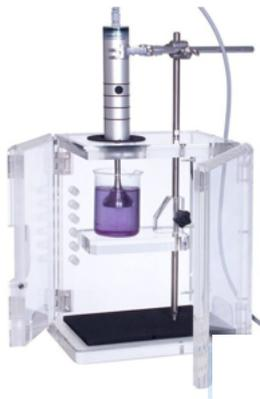
Звукоизоляционная коробка Hielscher из акрилового стекла, с делительным стержнем 16 мм, с вертушкой SPB-L
