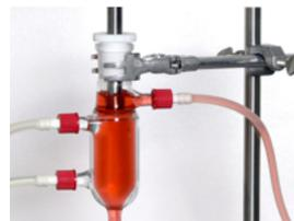
Измерительная ячейка Хильшера, стеклянная, с охлаждением, включая комплект для быстрого соединения, для жидкости GD14K
