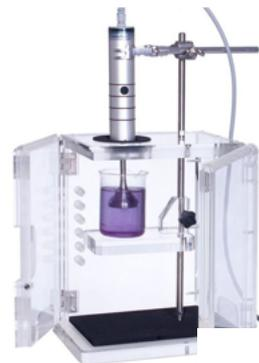
Hielscher звукоизоляционный ящик, из акрилового стекла, с делимым стержнем ? 16 мм, с верт. SPB-L
