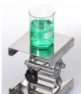
Hielscher LabLift для удобного позиционирования образцов под ультразвуковыми датчиками для контроля LabLift
